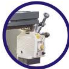
Caixa de Avanço Align AL-500, com avanços infinitamente variáveis, comandada por potenciômetro e boto-eira para movimento rápido
