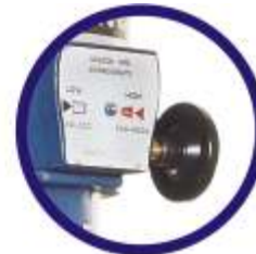
Cabeçote Standard, Motor 3 HP ISO 30, com velocidades variáveis (variador mecânico) de 60
