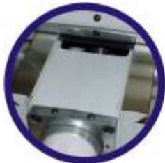
Barramento trapezoidal (rabo de andorinha) no eixo "y"
